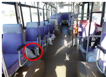
写真3-2 ウェイトの設置状況
