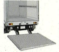
テールゲートリフターの例 ※「パワーゲート」「テールリフト」等、メーカーごとに商品名が異なることに注意
