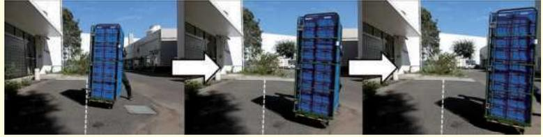
4 輪旋回（自在）タイプを傾いた路面で直進させようとしている様子
