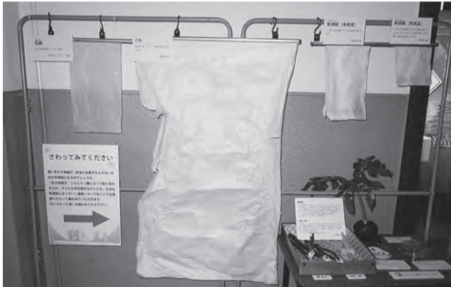
「風船爆弾」の気球紙の製造 左から①生紙(きがみ)＝何のそりもされていない和紙、②ごわ＝生紙5枚をこんやく糊で貼り合わせたもの、③気球紙(未完)＝ごわを25%炭酸ナトリウム溶液に浸したもの、④気球紙(完成)＝炭酸ナトリウム溶液に浸したごわを、さらに16%グリセリン溶液に浸したものの。完成品は鹿のなめし皮のような感じの質感
